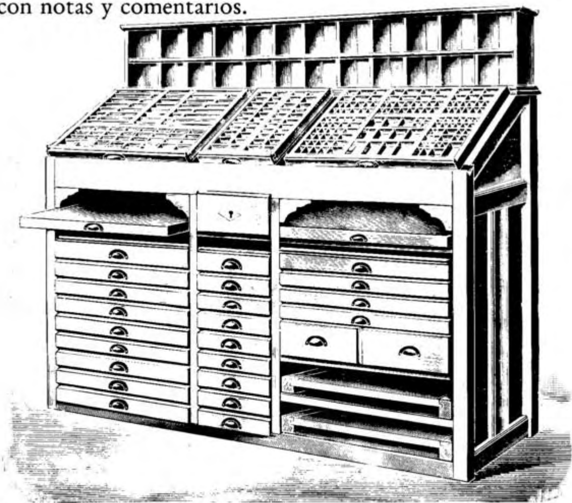
Comodín para remendería, con cajas planas con cajetines para tipos, cajas para quebrados, titulares, filetones, interlíneas, etc.
